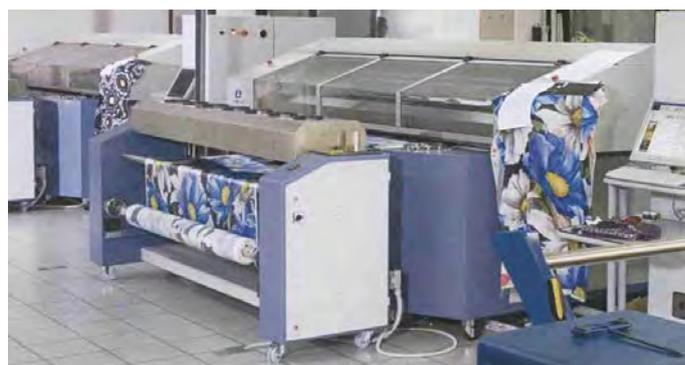
ごく少数です。しかしこの機器を実際に製作しているのは、イタリアのコモにある《ROBUSTELLI》社です。エプソンが開発しているテキスタイル用のプリンターヘッドを搭載し、同じくこのためだけに開発された純正の捺染用インクを使い、コモ地区では世界で最も優れたデジタル捺染プリンターとして評価されているとの事です。
